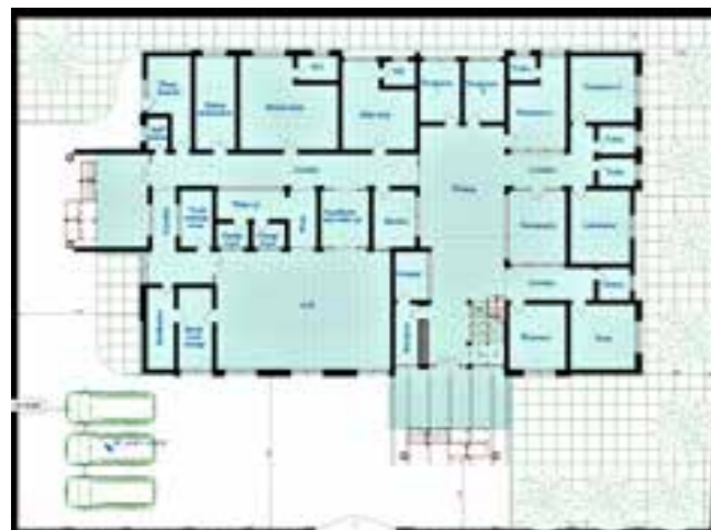
Der von uns entworfene Grundriss des Hospitals: links der Op.-Trakt, rechts die Ambulanz mit Labor, Pharmazie, Ultraschall- und Röntgen-Raum.
